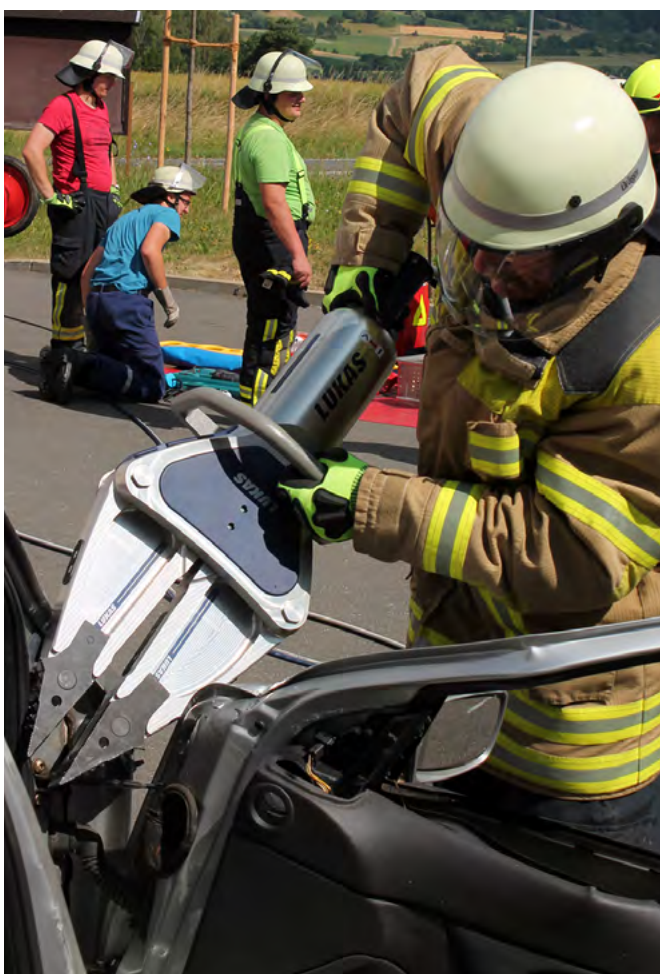
Der neue Spreizer im Einsatz – natürlich nur mit gesamter Persönlicher Schutzausrüstung. Rechts: Und auch mit den neuen Zylindern und Schwelleraufsätzen wurde trainiert.
