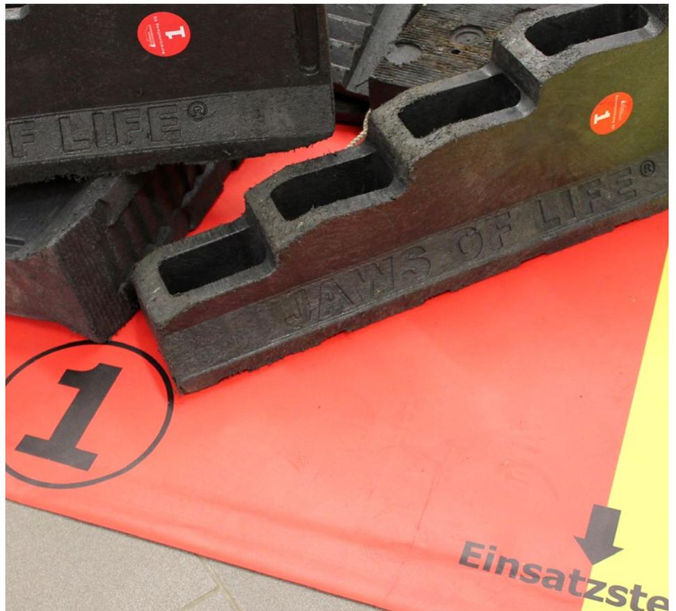
„Rot auf Rot“: Beispielsweise die Stufenklötze – sie dienen der Sicherung eines verunfallten Autos – sind mit dem roten Aufkleber markiert und gehören auf das erste Feld der neuen Plane. Foto: smü
