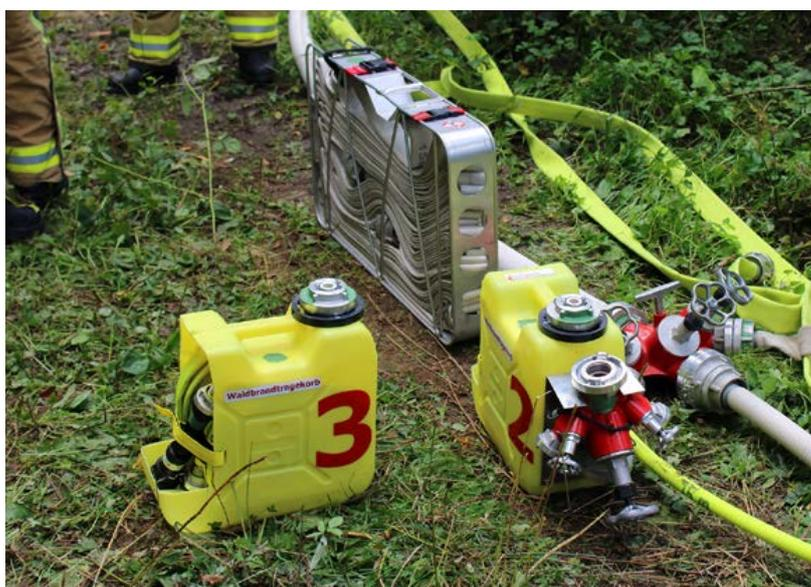
Ausgiebig im Einsatz war das Material des neuen Rollcontainers, hier die Waldbrandtragekörbe mit Schläuchen, Verteilern und Strahlrohren. Foto: KFV/Sailer
