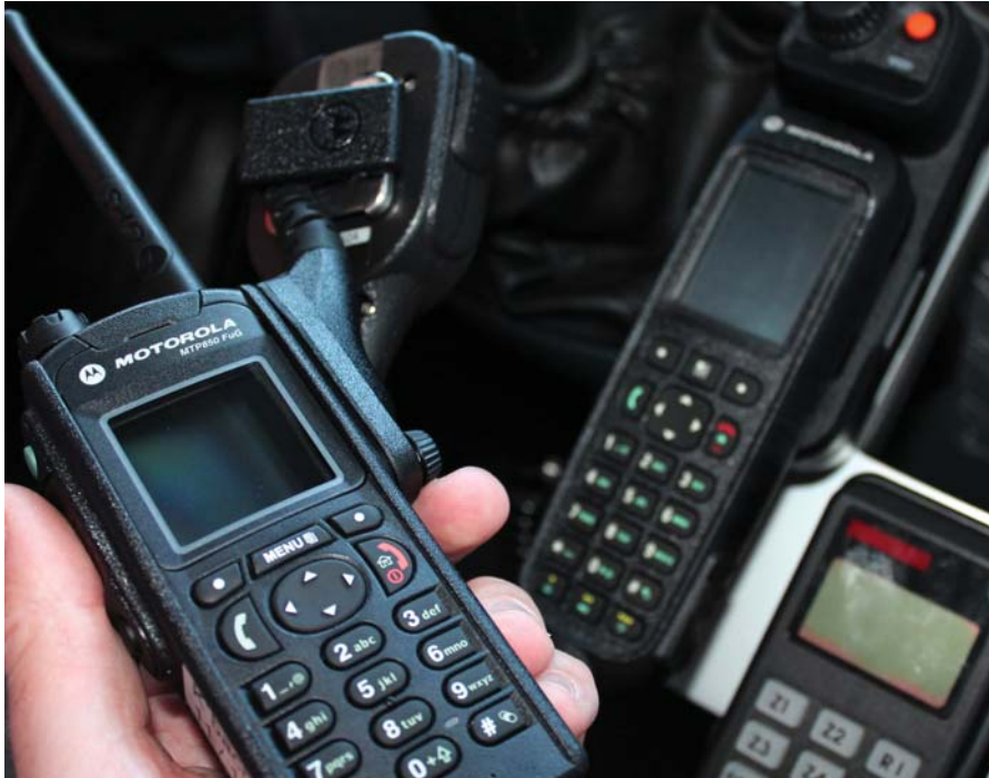
So sehen die Digitalfunkgeräte aus (links und Mitte). Rechts ist noch der Hörer für den Analogfunk eingebaut – die alte Funktechnik bleibt noch einige Zeit. Foto: smü
