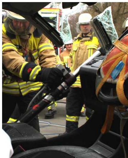
Fußraumverengung: Bevor der Zylinder eingesetzt wird (re.) muss die Rettungsschere ran.
